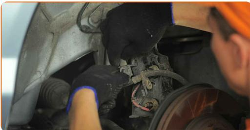
**36** En la pata fije el latiguillo del sistema de freno.
