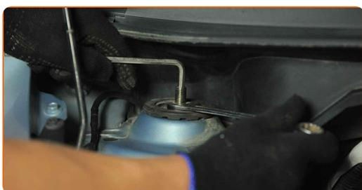
20 Retire la pata amortiguadora.
