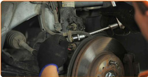
**38** Trate las sujeciones del amortiguador. Use grasa de cobre.
