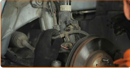
**37** Apriete la sujeción del latiguillo de freno. Use un vaso de impacto del n.º 12. Utilice una llave de trinquete.
