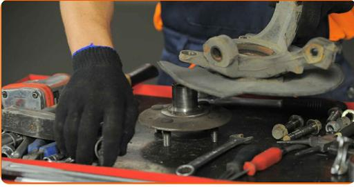
**32** Retire el anillo de retención del cojinete del cubo de rueda. Use alicates de punta redondeada. Utilice un destornillador plano.
