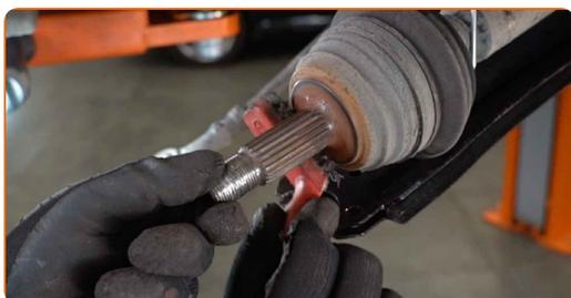
**43** Instale la mangueta de dirección en el eje de la junta homocinética.
