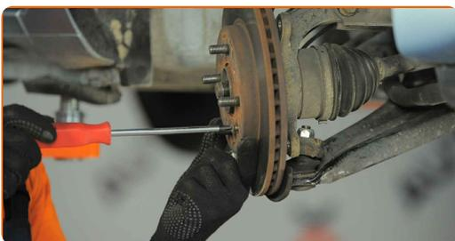
50 Limpie los asientos de montaje de la pinza de freno y su soporte. Use un cepillo de alambre. Use el aerosol WD-40.
