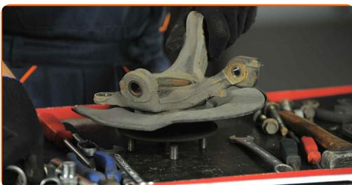
**31** Saque el cubo de rueda del muñón de dirección. Utilice un juego de cubos y rodamientos. Utilice un martillo.
