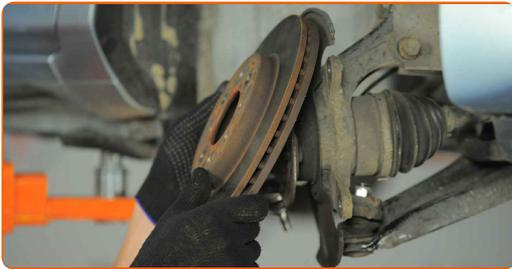
49 Apriete la fijación del disco de freno. Utilice un destornillador Phillips. Utilice una llave dinamométrica. Apriételo a un par de 10 Nm.
