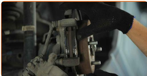
**35** Establezcan el soporte de freno y lo fijen. Use un vaso de impacto del n.º 12. Utilice una llave dinamométrica. Apriételo a un par de 23 Nm.
