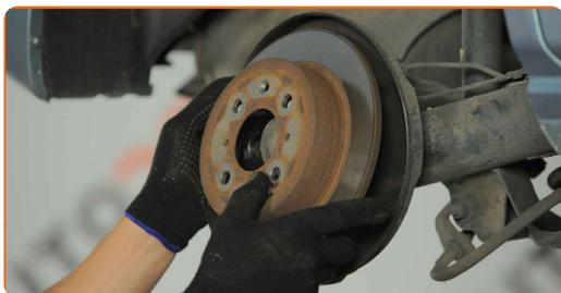
**29** Apriete la fijación del disco de freno. Utilice un destornillador Phillips. Utilice una llave dinamométrica. Apriételo a un par de 10 Nm.
