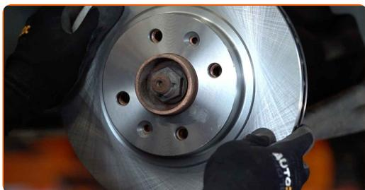
**15** Apriete la fijación del disco de freno. Utilice Torx T30. Utilice una llave dinamométrica. Apriételo a un par de 14 Nm.
