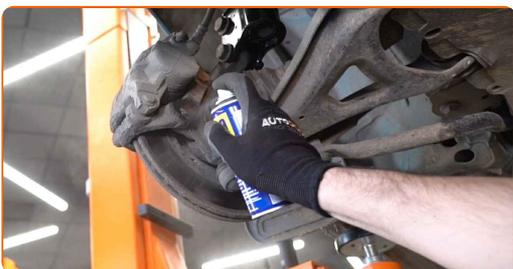
**9** Destornille la fijación de la pinza del cáliper de freno. Use un vaso de impacto del n.º 18. Utilice una llave de trinquete. Utilice una llave giramachos.
