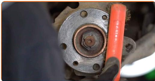
**14** Instale el disco de freno nuevo en el cubo y atornille los tornillos de fijación.
