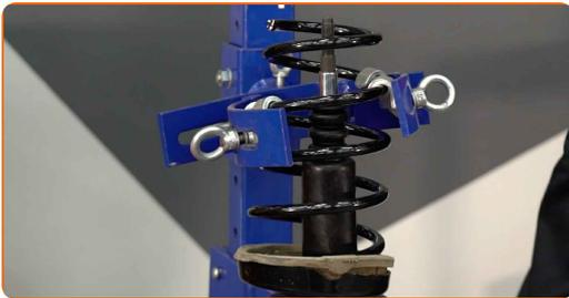
28 Instale el soporte de montaje superior del puntal y el cojinete del soporte de montaje del puntal.
