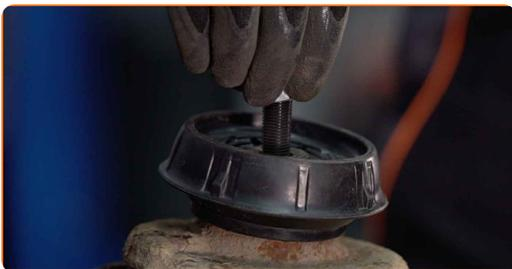
29 Apriete la tuerca de la varilla de la pata amortiguadora. Use Vaso HEX No. H6. Usa una llave mixta del n.º 14. Utilice una llave dinamométrica. Apriételo a un par de 60 Nm.
