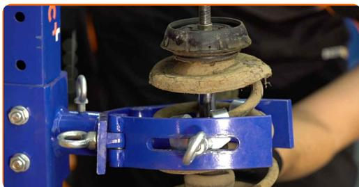
18 Destornille la tuerca de la varilla de la pata amortiguadora. Use Vaso HEX No. H6. Usa una llave mixta del n.º 14. Utilice una llave de trinquete.
