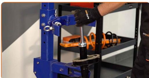
25 Instale el guardapolvo y el tope en el amortiguador nuevo.
