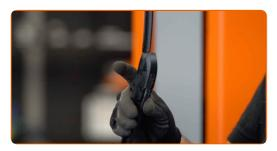
Presione el clip de fijación. Retire la escobilla del brazo del limpiaparabrisas.
