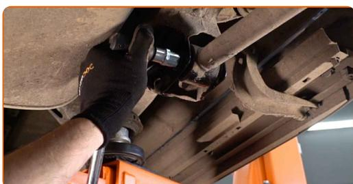
**9** Sostenga el eje de torsión de la suspensión trasera. Utilice un gato de transmisión hidráulica.
