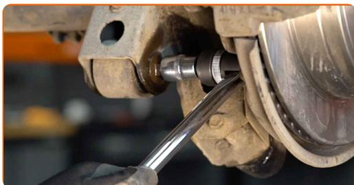
**8** Desatornille la sujeción que conecta el brazo de arrastre a la carrocería del automóvil. Usa una llave mixta del n.º 19. Use un vaso de impacto del n.º 19. Utilice una llave giramachos.
