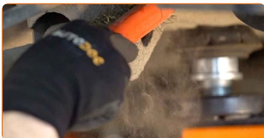
**7** Destornille la fijación de la palanca a la viga. Use un vaso de impacto del n.º 19. Utilice una llave giramachos.
