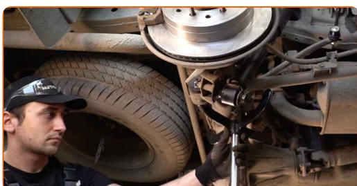
**10** Limpie el soporte del freno de estacionamiento. Use un cepillo de alambre. Use el aerosol WD-40.
