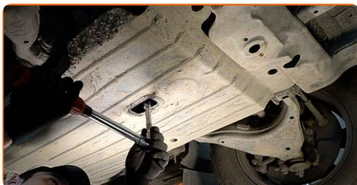
**15** Apriete el tapón de drenaje de aceite. Use un vaso de impacto del n.º 17. Utilice una llave dinamométrica. Apriételo a un par de 30 Nm.
