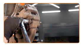
Trate la superficie donde el disco del freno entra en contacto con la llanta de la rueda. Use grasa de cobre.
