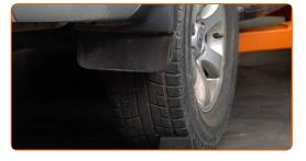
Afloje los pernos de fijación de la rueda. Utilice una llave de impacto para llanta # 21.
