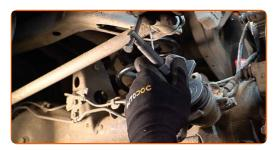
Trate las pastillas de freno en el área donde su superficie entra en contacto con el soporte de la pinza de freno. Use pasta antichirridos.
