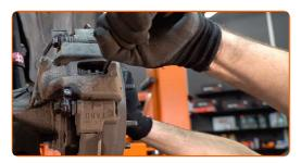
Destornille la fijación del cáliper de freno. Use un vaso de impacto del n.º 17. Utilice una llave giramachos.
