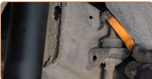
**7** Sostenga el eje de torsión de la suspensión trasera. Utilice un gato de transmisión hidráulica.
