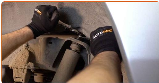
**9** Destornille la fijación inferior del amortiguador. Use un vaso de impacto del n.º 17. Utilice una llave giramachos.
