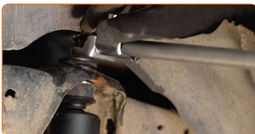
**19** Trate las sujeciones del amortiguador. Use grasa de cobre.
