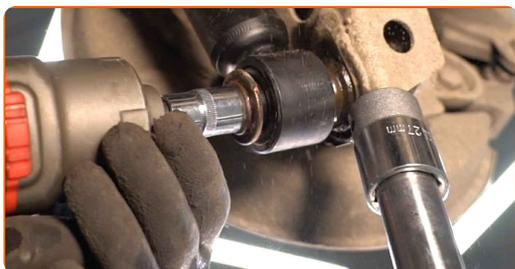
**17** Atornille la sujeción superior del amortiguador. Usa una llave mixta del n.º 17.
