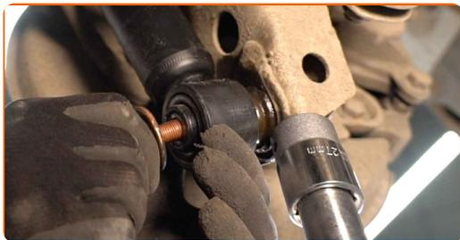
**16** Atornille la sujeción inferior del amortiguador. Use un vaso de impacto del n.º 17.
