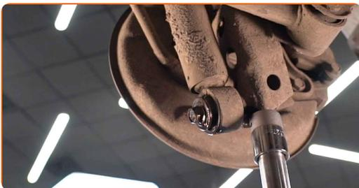
**8** Destornille la fijación superior del amortiguador. Use una llave mixta del n.º 17. Utilice alicates de bloqueo.
