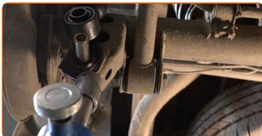
**20** Instale la barra del estabilizador de estabilidad transversal.
