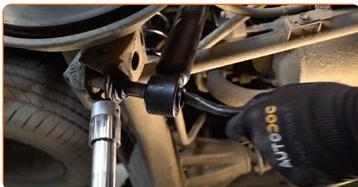
**24** Atornille la sujecion inferior del amortiguador. Use un vaso de impacto del n.º 17.
