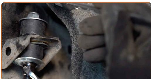
**23** Conecte la parte inferior del amortiguador.
