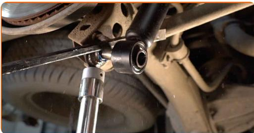
**9** Limpie las sujeciones de la bieleta o enlace estabilizador. Use un cepillo de alambre. Use el aerosol WD-40.
