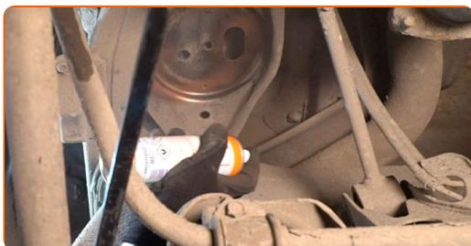
**17** Tire hacia abajo la viga de suspensión trasera. Use una palanca.
