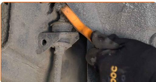
**10** Desatornille las sujeciones que conectan la bieleta de barra estabilizadora al eje de torsión de la suspensión trasera. Use una llave mixta del n.º 12. Use una llave mixta del n.º 14.
