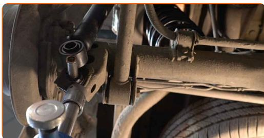
**22** Atornille las sujeciones que conectan la bieleta de barra estabilizadora al eje de torsión de la suspensión trasera. Usa una llave mixta del n.º 12. Usa una llave mixta del n.º 14.
