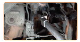
Apriete la fijación del soporte esférico. Use un vaso de impacto del n.º 19. Utilice una llave dinamométrica. Apriételo a un par de 110 Nm.
