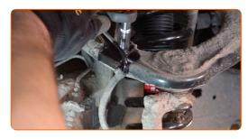
Quite el soporte de fijación de los cables del captador ABS del brazo superior.
