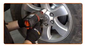
Baje el automóvil y, manteniendo el orden cruzado, apriete los pernos de fijación de las ruedas. Utilice una llave dinamométrica. Apriételo a un par de 112 Nm.
