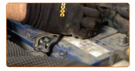
Atornille la abrazadera de sujeción de la batería. Use un vaso de impacto del n.º 10. Utilice una llave de trinquete.
