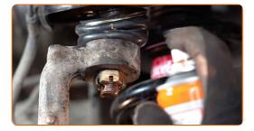
Instale el pasador de sujeción. Use alicates de punta redondeada. Utilice un destornillador plano.
