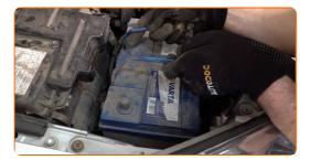
Instale la abrazadera de sujeción de la batería.
