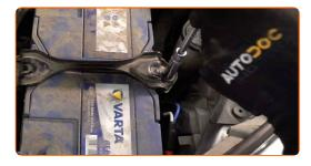
Retire la abrazadera de sujeción de la batería.
