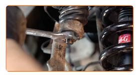
Apriete la sujeción que conecta el brazo de arrastre a la carrocería del automóvil. Usa una llave mixta del n.º 19. Utilice una llave dinamométrica. Apriételo a un par de 115 Nm.
