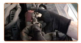
Desatornille la abrazadera de sujeción de la batería. Use un vaso de impacto del n.º 10. Utilice una llave de trinquete.
