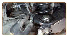
Apriete el soporte del cable ABS. Use un vaso de impacto del n.º 12. Utilice una llave de trinquete.
