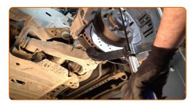
Desconecte el brazo de control superior de la mangueta de dirección. Use una palanca.
