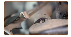
Desatornille la sujeción que conecta el brazo de arrastre a la carrocería del automóvil. Usa una llave mixta del n.º 19.
