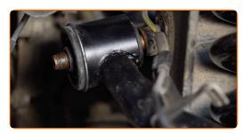
Conecte el brazo de control superior a la mangueta de dirección.
