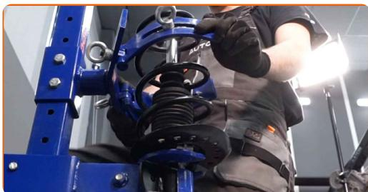
**31** Instale el soporte de montaje superior del puntal y el cojinete del soporte de montaje del puntal.
