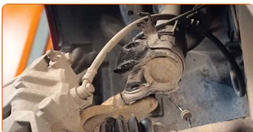
**20** Destornille la fijación superior de la cazoleta de la pata amortiguadora. Use un vaso de impacto del n.º 13.
