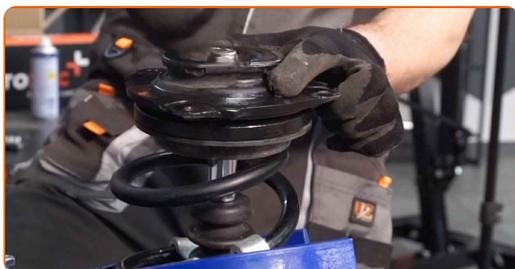
**32** Apriete la tuerca de la varilla de la pata amortiguadora. Use un vaso de impacto del n.º 18. Use Vaso HEX No. H6. Utilice una llave dinamométrica. Apriételo a un par de 68 Nm.
