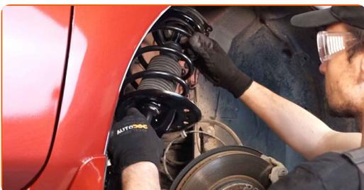
**36** Atornillen la fijación superior de la cazoleta de la pata amortiguadora. No lo apriete.
