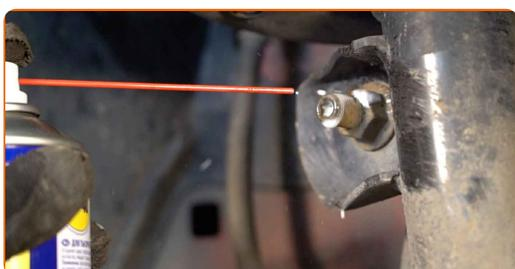
**14** Destornille la tuerca y quite la barra del estabilizador desde la pata amortiguadora. Use un vaso de impacto del n.º 18.
