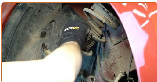
**22** Instale la pata amortiguadora en el mecanismo para apretar los resortes.
