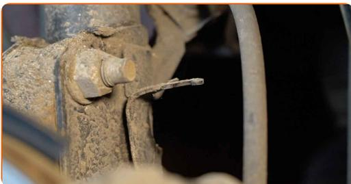
**12** Desconecte los cables eléctricos y el latiguillo de freno del soporte en la pata amortiguadora. Use una palanca.
