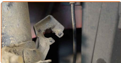
**13** Limpie las fijaciones que conectan la bieleta de la barra estabilizadora al puntal amortiguador, y aquellos que conectan el puntal del amortiguador a la mangueta de rueda. Use un cepillo de alambre. Use el aerosol WD-40.
