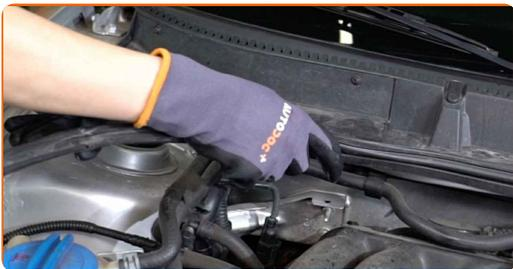
**4** Desenrosque las sujeciones del panel de plástico. Utilice un destornillador Phillips.
