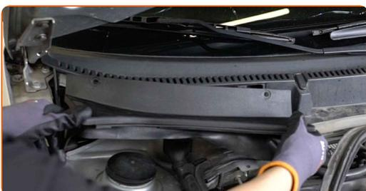
**16** Enrosque las sujeciones del panel de plástico. Utilice un destornillador Phillips.
