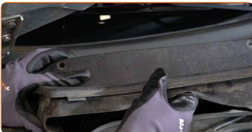
**6** Retire la cubierta de la carcasa del filtro del habitáculo.
