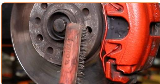
**79** Trate la superficie donde el disco del freno entra en contacto con la llanta de la rueda. Utilice grasa cerámica.
