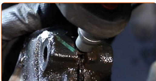
**33** Desconecte el muñón de dirección de la pata amortiguadora.
