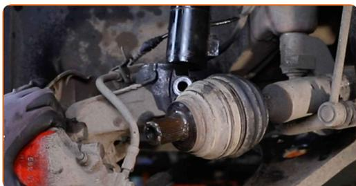
**34** Desatornille las sujeciones superiores del amortiguador.
