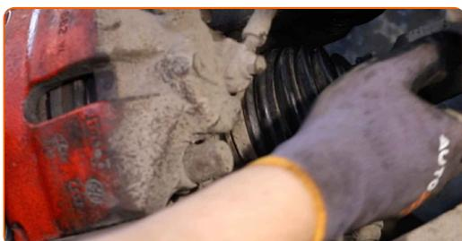
**65** Instale y apriete el perno del eje de transmisión.
