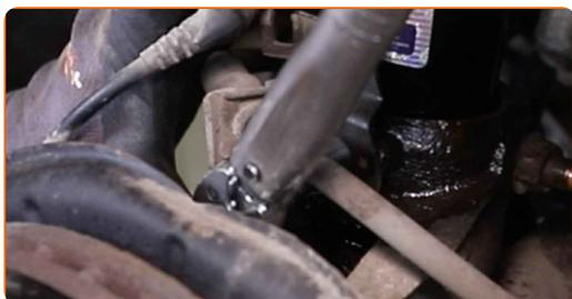
**77** Conecte los cables del captador ABS.
