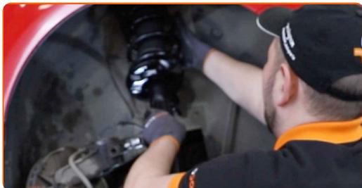
**59** Fije las sujeciones superiores del puntal amortiguador. No lo apriete.
