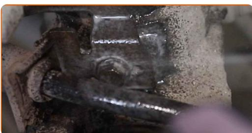
**20** Desenrosque la sujeción que conecta el soporte del latiguillo de freno al puntal de suspensión. Usa una llave mixta del n.º 10.
