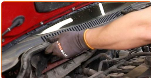
**90** Enrosque las sujeciones del panel de plástico. Utilice Torx T30. Utilice una llave de trinquete.
