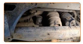
Coloque un contenedor para el aceite de desecho con al menos 5 l de capacidad debajo del orificio de drenaje.
