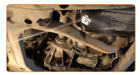
Atornille en el nuevo tapón de drenaje y apriételo. Use un vaso de impacto del n.º 14. Utilice una llave dinamométrica. Apriételo a un par de 27 Nm.
