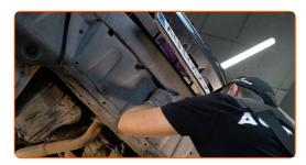
Apriete los sujetadores de la cubierta inferior del cárter de aceite. Use un vaso de impacto del n.º 10. Utilice una llave de trinquete.
