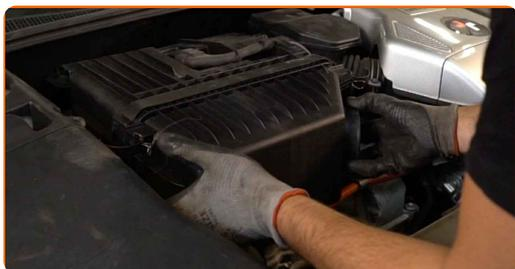
**99** Presione los clips de la cubierta del filtro de aire en su lugar.
