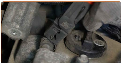
**24** En el lado derecho, desconecte la manguera de la válvula PCV de la cubierta del motor.
