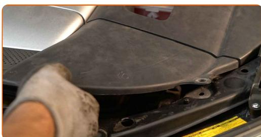
**12** Retire los clips de la cubierta protectora del motor.
