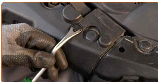
**4** Instale la cubierta del soporte del radiador.
