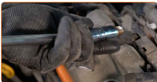
**56** Aplique una capa fina de un lubricante antigripado especial de alta temperatura a las roscas de las nuevas bujías.
