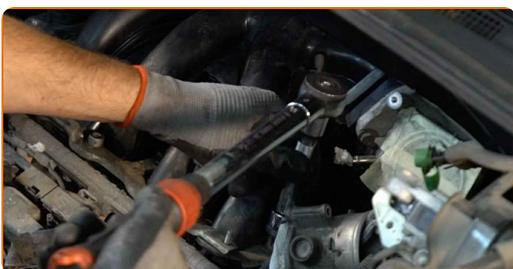
**70** Apriete las sujeciones del colector de admisión. Use Vaso HEX No. H8. Utilice una llave dinamométrica. Apriételo a un par de 15 Nm.
