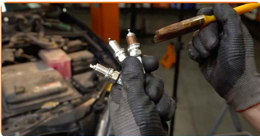
**57** Instale las nuevas bujías en sus asientos de montaje. Use el vaso de bujía # 16. Utilice una llave de trinquete.
