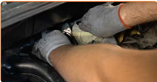
**72** Conecte el cuerpo del acelerador al colector de admisión.
