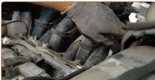
**36** Separe los conectores de la válvula del acelerador.
