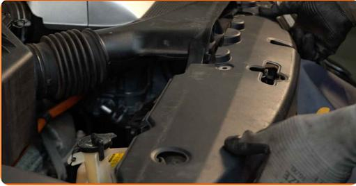
**104** Instale los clips de la cubierta del soporte del radiador.
