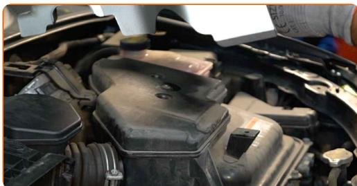
**14** Desatornille las sujeciones de la caja del filtro de aire. Use un vaso de impacto del n.º 10. Utilice una llave de trinquete.
