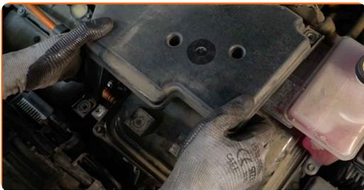
**16** Desenchufe el conector del sensor de flujo de aire. Utilice un destornillador plano.
