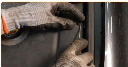
**13** Retire la cubierta del motor.
