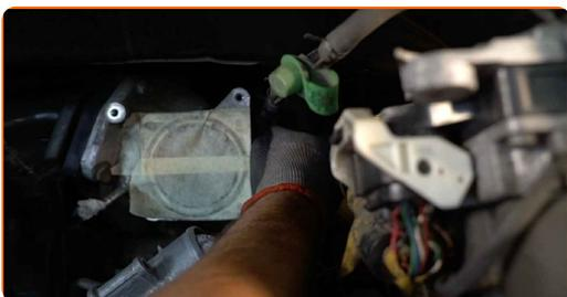
**69** Apriete las sujeciones del colector de admisión. Use un vaso de impacto del n.º 14. Utilice una llave dinamométrica. Apriételo a un par de 15 Nm.
