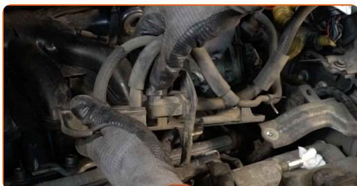
**79** Atornille el soporte del sistema de vacío. Use un vaso de impacto del n.º 12. Utilice una llave de trinquete.
