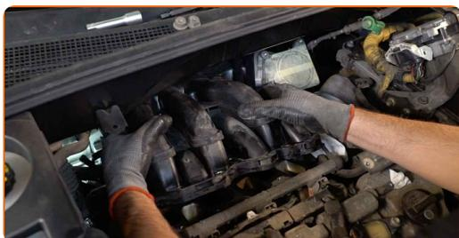
**66** Apriete las sujeciones del colector de admisión. Use Vaso HEX No. H8. Utilice una llave de trinquete.
