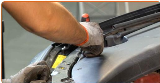
**21** Retire la cubierta de la batería.
