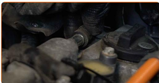
**88** Instale la abrazadera del manguito de ventilación del cárter. Utilice alicates para abrazaderas clic-R.
