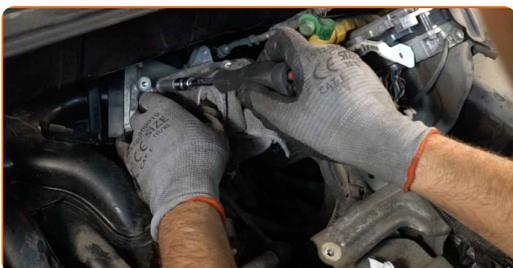
**74** Fije el manguito de ventilación del cárter a la cubierta del motor a la izquierda.
