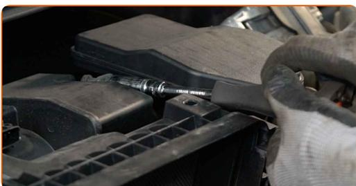
**18** Destornille los bulones de fijación del cuerpo del filtro. Use un vaso de impacto del n.º 10. Utilice una llave de trinquete.
