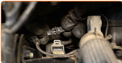
**77** Conecte los conectores de la válvula del acelerador.
