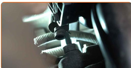
**34** Separe el manguito de ventilación del cárter de la cubierta del motor en la izquierda.
