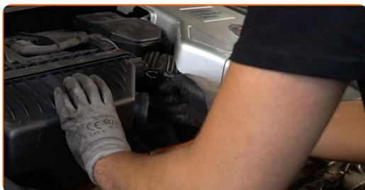
**100** Instale la carcasa del conducto de aire.
