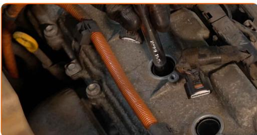
**58** Atornille las bujías nuevas y apriételas. Use el vaso de bujía # 16. Utilice una llave dinamométrica. Apriételo a un par de 26 Nm.
