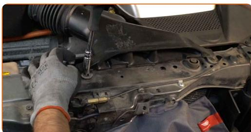
**102** Atornille la abrazadera de sujeción que conecta el conducto de aire a la carcasa del filtro de aire. Use un vaso de impacto del n.º 10. Utilice una llave de trinquete.
