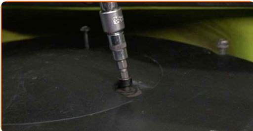
14 Apriete los tornillos de fijación de la tapa del filtro de aire. Use Vaso HEX No. H5. Utilice una llave dinamométrica. Apriételo a un par de 8 Nm.
