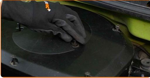
13 Atornille los tornillos de sujeción de la cubierta del filtro de aire. Utilice un destornillador Phillips. Use Vaso HEX No. H5. Utilice una llave de trinquete.
