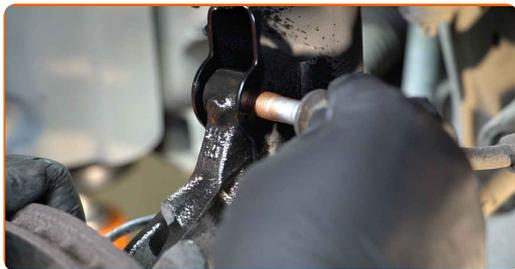
**38** Apriete las sujeciones inferiores que conectan el amortiguador con la mangueta de dirección. Use una llave mixta del n.º 18. Use un vaso de impacto del n.º 18. Utilice una llave dinamométrica. Apriételo a un par de 40 Nm.+90°
