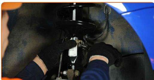
**40** Conecte los cables del captador ABS.
