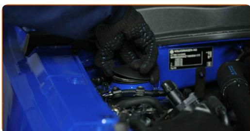
**15** Destornille la fijación superior de la cazoleta de la pata amortiguadora. Use un vaso de impacto del n.º 21. Use Vaso HEX No. H6. Utilice una llave de trinquete.
