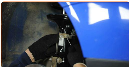
**7** Desconecte el cableado del captador ABS.
