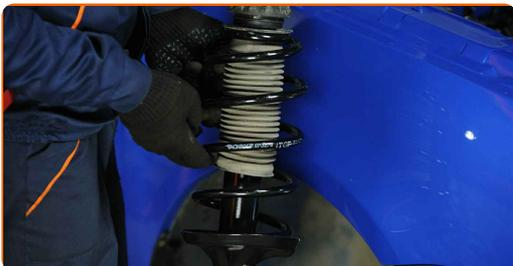
**31** Atornillen la fijación superior de la cazoleta de la pata amortiguadora.
