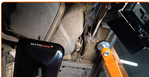
**3** Destornille el tapón de desagüe. Use un vaso de impacto del n.º 19. Utilice una llave de trinquete.
