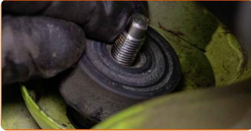
**31** Atornille la sujeción superior del amortiguador. Use un vaso de impacto del n.º 16. Utilice un vaso para amortiguador DDNº6 Utilice una llave de trinquete.
