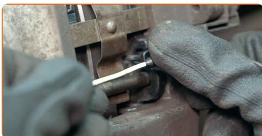
**19** Conecte la clavija del sensor de desgaste de las pastillas de freno.
