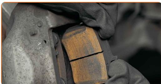
**11** Retire el sensor de desgaste de las pastillas de freno de la pastilla de freno.
