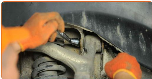
**17** Retire el perno de sujeción. Utilice un martillo.
