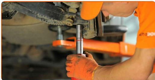
**36** Apriete la fijación de la palanca inferior. Usa una llave mixta del n.º 21. Use un vaso de impacto del n.º 21. Utilice una llave dinamométrica. Apriételo a un par de 135 Nm.
