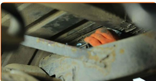
**13** Limpie las sujeciones de la bieleta o enlace estabilizador. Use un cepillo de alambre. Use el aerosol WD-40.
