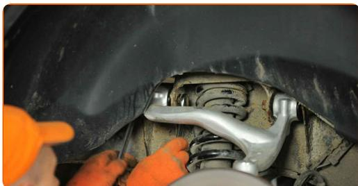
**38** Apriete la sujeción delantera que conecta el brazo de control al subchasis. Usa una llave mixta del n.º 18 (2 piezas). Utilice una llave dinamométrica. Apriételo a un par de 120 Nm.
