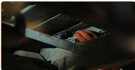
**33** Apriete la fijación superior del soporte esférico. Usa una llave mixta del n.º 19. Utilice una llave dinamométrica. Apriételo a un par de 50 Nm.
