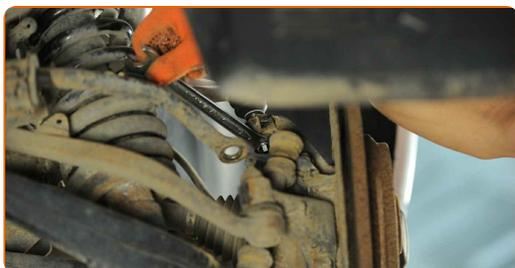
**31** Atornille la atadura superior del soporte del mostrador del amortizador. Usa una llave mixta del n.º 13. Use un vaso de impacto del n.º 13. Utilice una llave dinamométrica. Apriételo a un par de 20 Nm.
