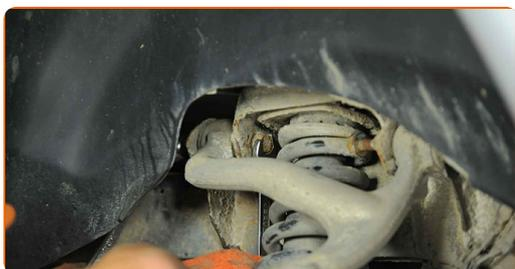
**19** Destornille la fijación de la palanca inferior. Usa una llave mixta del n.º 21. Use un vaso de impacto del n.º 21. Utilice una llave de trinquete.
