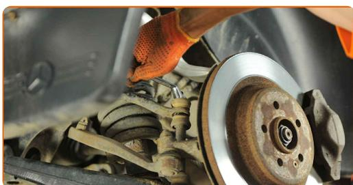
**41** Instale la fijación de la varilla a la palanca y apriétela. Use una llave mixta del n.º 13. Utilice una llave dinamométrica. Apriételo a un par de 28 Nm.
