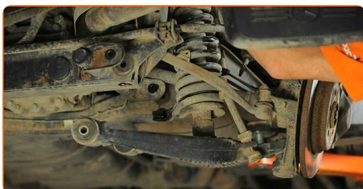
**22** Retire el perno de sujeción.
