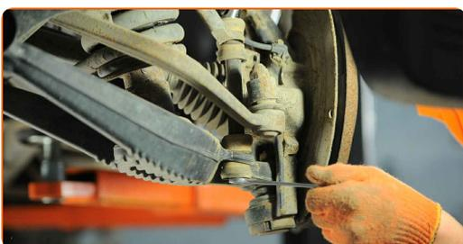
**16** Destornille la fijación delantera de la palanca. Usa una llave mixta del n.º 18 (2 piezas).
