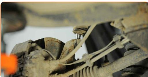
**10** Quite la tapa del soporte del amortiguador. Utilice un destornillador plano.
