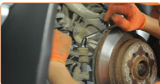
**15** Afloje los sujeciones que conectan la bieleta de barra estabilizadora. Usa una llave mixta del n.º 13.
