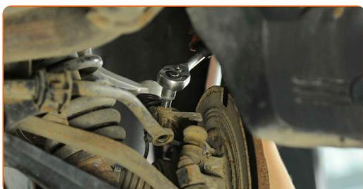
**34** Atornille la sujeción que conecta el sensor de ABS con la mangueta de dirección trasera. Use un vaso de impacto del n.º 10. Utilice una llave de trinquete.
