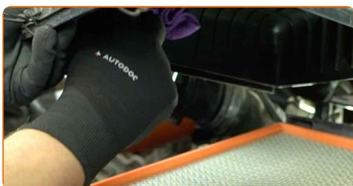
**6** Retire el elemento filtrante de la carcasa del filtro.
