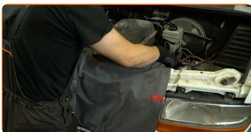
3 Desenganche los clips de la cubierta del filtro de aire.
