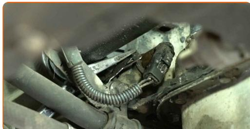
3 Retire el sensor de posición del cigüeñal.
