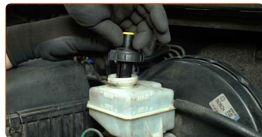
Afloje el tapón del depósito del líquido de frenos.
