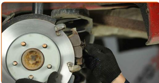
**28** Trate el pistón de la pinza de freno. Utilice un cepillo de limpieza de nylon. Use un limpiador de frenos.
