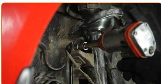
**8** Retire el soporte del arnés de cables del ABS.
