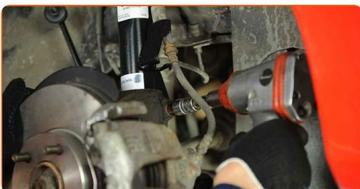
**49** En la pata fije el latiguillo del sistema de freno.
