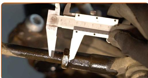
**7** Limpie la tuerca de bloqueo que conecta el tirante de dirección al terminal de dirección. Use un cepillo de alambre. Use el aerosol WD-40.
