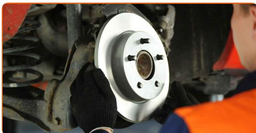
**18** Limpie las sujeciones del rodamiento del cubo de rueda. Use un cepillo de alambre. Use el aerosol WD-40.
