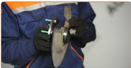
**32** Instale el cojinete del cubo junto con la placa de protección del disco de freno.
