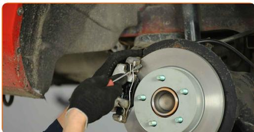
**49** Trate la superficie donde el disco del freno entra en contacto con la llanta de la rueda. Use grasa de cobre.
