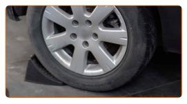
Afloje los pernos de fijación de la rueda. Utilice una llave de impacto para llanta # 19.
