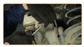
Destornille la fijación del cáliper de freno. Use Vaso HEX No. H7. Utilice una llave de trinquete.
