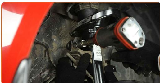
**55** Trate las sujeciones del amortiguador. Trate todas las juntas de la bieleta o enlace estabilizador. Use grasa de cobre.
