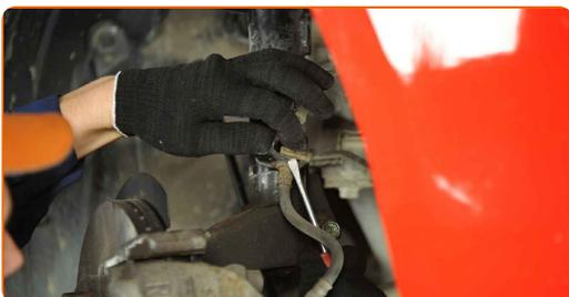
**11** Separe el latiguillo de freno del puntal amortiguador.
