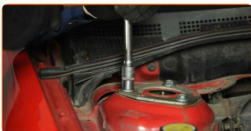
**41** Trate las sujeciones del soporte del amortiguador. Use grasa de cobre.
