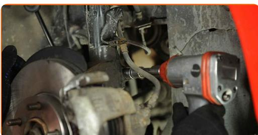
**14** Retire el perno de sujeción.
