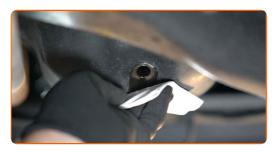
Atornille en el nuevo tapón de drenaje y apriételo. Use un vaso de impacto del n.º 19. Utilice una llave dinamométrica. Apriételo a un par de 28 Nm.
