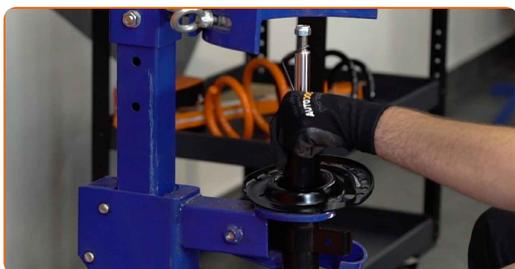
**29** Instale el guardapolvo y el tope en el amortiguador nuevo.
