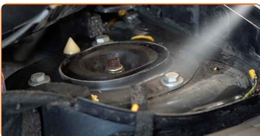
**5** Afloje la sujeción superior del soporte del amortiguador. Use un vaso de impacto del n.º 13. Utilice una llave de trinquete.
