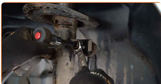
**14** Limpie las sujeciones que conectan el puntal amortiguador a la mangueta de dirección. Use un cepillo de alambre. Use el aerosol WD-40.
