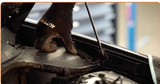
**51** Instale los retenedores de la tapa del soporte del amortiguador.
