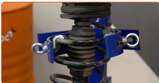
**22** Destornille la tuerca de la varilla de la pata amortiguadora. Use Vaso HEX No. H6. Usa una llave mixta del n.º 18. Utilice una llave de trinquete.
