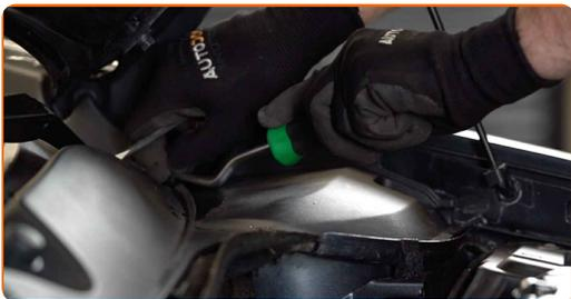
**4** Levante un poco la tapa del soporte del amortiguador. Trate las sujeciones del soporte del amortiguador. Use el aerosol WD-40.
