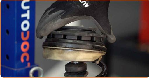
25 Apriete la tuerca de la varilla de la pata amortiguadora. Use Vaso HEX No. H6. Usa una llave mixta del n.º 18. Utilice una llave dinamométrica. Apriételo a un par de 62 Nm.
