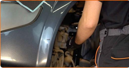
29 Fije las sujeciones superiores del puntal amortiguador (3 piezas). No lo apriete.
