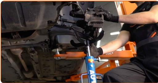
33 Instale y apriete un nuevo perno de la mangueta de dirección. Use un vaso de impacto del n.º 19. Usa una llave mixta del n.º 19. Utilice una llave dinamométrica. Apriételo a un par de 105 Nm.
