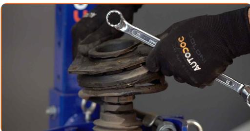
24 Instale el soporte superior nuevo de la pata amortiguadora.
