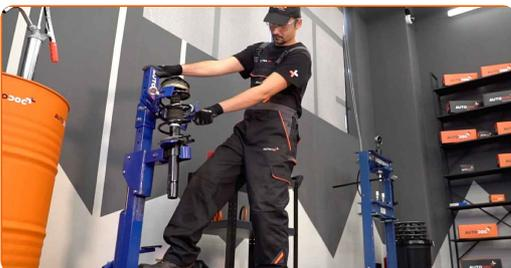
27 Retire el puntal amortiguador que está montado.
