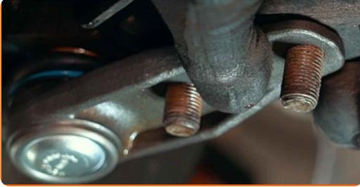
20 Atornille la sujeción que conecta la rótula al brazo de control. Usa una llave mixta del n.º 18. Use un vaso de impacto del n.º 18. Utilice una llave de trinquete.
