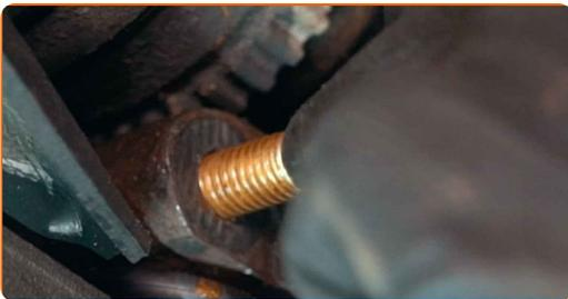
22 Atornille la sujeción que conecta la rótula a la mangueta de dirección. Usa una llave mixta del n.º 16. Use un vaso de impacto del n.º 16. Utilice una llave de trinquete.
