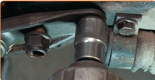
21 Instale el perno de sujeción.
