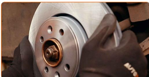
**20** Apriete la fijación del disco de freno. Utilice Torx T40. Utilice una llave dinamométrica. Apriételo a un par de 14 Nm.
