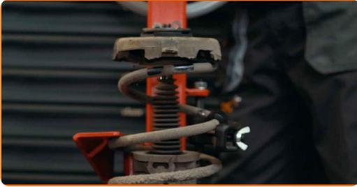
27 Trate la varilla del amortiguador. Use un cepillo de alambre. Use el aerosol WD-40.
