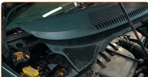
6 Retire las sujeciones de la tapa del soporte del amortiguador.
