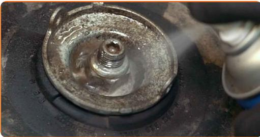
28 Destornille la tuerca de la varilla de la pata amortiguadora. Vaso para tuerca de amortiguador de 21 mm. Use Vaso HEX No. H6.
