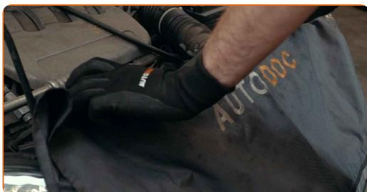
3 Desenrosque las sujeciones de la rejilla del limpiaparabrisas. Utilice Torx T20. Utilice una llave de trinquete.
