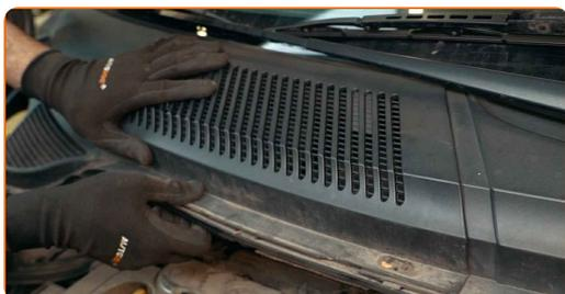
65 Instale y asegure la rejilla del capó. Utilice Torx T20. Utilice una llave de trinquete.
