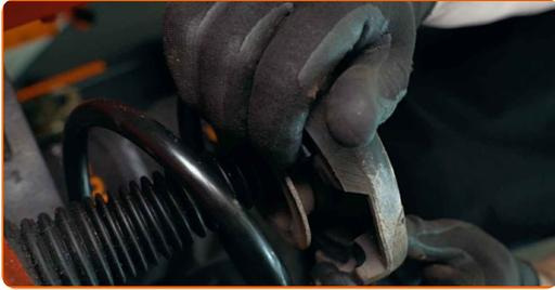
39 Apriete la tuerca de la varilla de la pata amortiguadora. Vaso para tuerca de amortiguador de 21 mm. Use Vaso HEX No. H6. Utilice una llave dinamométrica. Apriételo a un par de 60 Nm.
