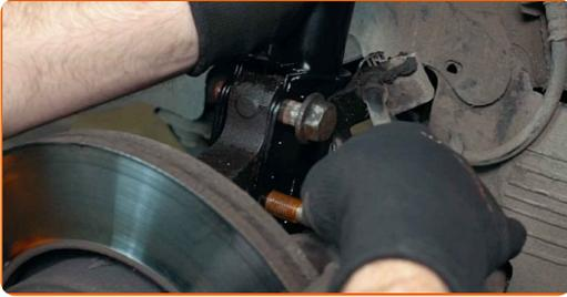
48 Atornille las sujeciones que conectan el puntal de suspensión con la mangueta de dirección. Usa una llave mixta del n.º 21. Use un vaso de impacto del n.º 21. Utilice una llave de trinquete.
