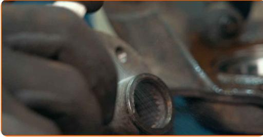
**39** Ajuste a presión un cojinete nuevo en el cubo de rueda. Utilice un juego de cubos y rodamientos.
