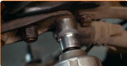
**50** Apriete las sujeciones que conectan la rótula al brazo de control. Use un vaso de impacto del n.º 18. Utilice una llave dinamométrica. Apriételo a un par de 75 Nm.
