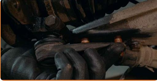
**49** Atornille la sujeción que conecta la rótula al brazo de control. Use una llave mixta del n.º 18. Use un vaso de impacto del n.º 18. Utilice una llave de trinquete.
