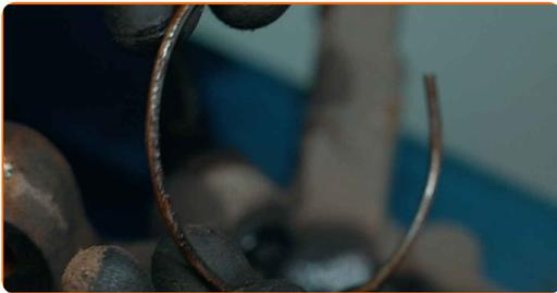
**33** Presione para extraer el aro de rodamiento interior que queda en el cubo. Utilice un separador de rodamientos. Utilice un juego de cubos y rodamientos.
