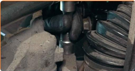
68 Conecte la sujeción del latiguillo de freno al puntal de suspensión.
