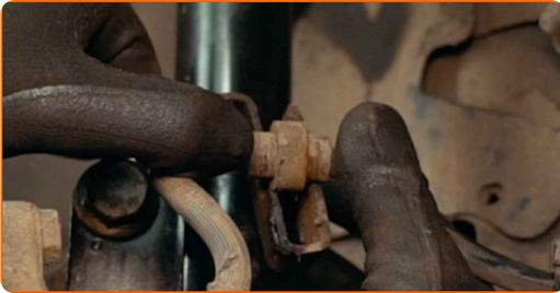
69 Trate todas las conexiones de la rótula de la barra de dirección Trate las sujeciones del amortiguador. Trate las sujeciones de la rótula. Use grasa de cobre.
