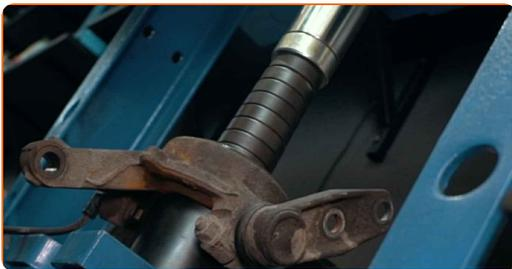
**35** Limpie el asiento de montaje del cojinete del cubo (buje). Use un cepillo de alambre. Use el aerosol WD-40.
