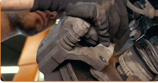
67 Apriete la fijación de la pinza del cáliper de freno. Use un vaso de impacto del n.º 18. Utilice una llave dinamométrica. Apriételo a un par de 100 Nm.
