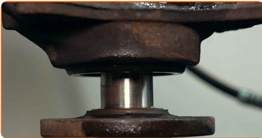
**40** Limpie la sujeción inferior que conecta el puntal de suspensión con la mangueta de dirección. Use un cepillo de alambre. Use el aerosol WD-40.
