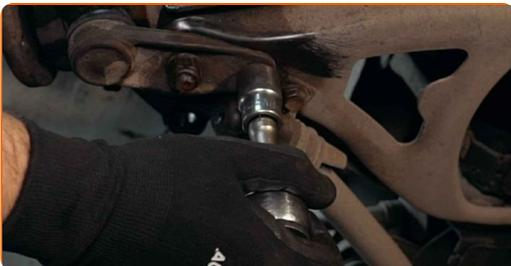
**51** Atornille las sujeciones que conectan el puntal de suspensión con la mangueta de dirección. Use una llave mixta del n.º 21. Use un vaso de impacto del n.º 21. Utilice una llave de trinquete.
