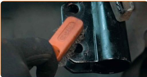
**41** Limpie las ranuras de la junta homocinética del eje de transmisión. Use un cepillo de alambre. Use el aerosol WD-40.
