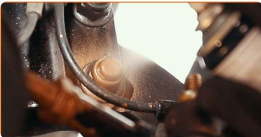
**70** Trate la superficie donde el disco del freno entra en contacto con la llanta de la rueda. Use grasa de cobre.
