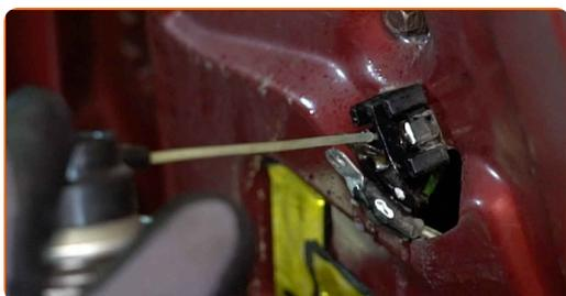
**25** Atornille los terminales del mecanismo del elevalunas. Utilice un destornillador Phillips.
