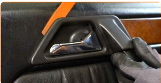
**5** Desenrosque la sujeción del panel de la puerta. Use un vaso de impacto del n.º 10. Utilice una llave de trinquete.
