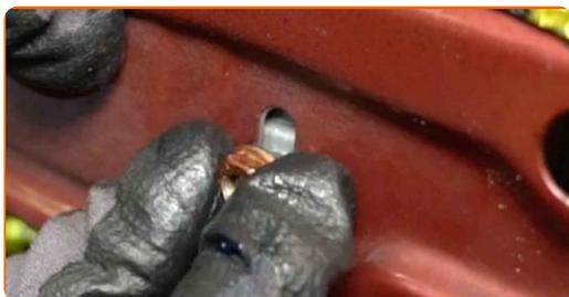
**23** Apriete las sujeciones del ensamblaje del regulador de ventana. Use un vaso de impacto del n.º 10. Utilice una llave dinamométrica. Apriételo a un par de 8 Nm.
