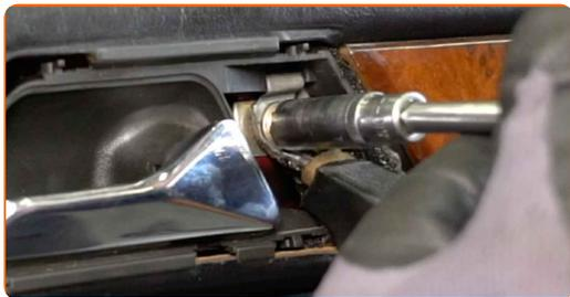
**6** Retire el embellecedor que cubre las sujeciones del espejo retrovisor lateral.
