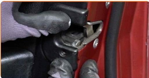
**35** Atornille la sujeción de la cubierta de la cerradura de la puerta. Utilice un destornillador plano.
