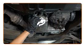
Atornille en el nuevo tapón de drenaje y apriételo. Use un vaso de impacto del n.º 18. Utilice una llave dinamométrica. Apriételo a un par de 29 Nm.
