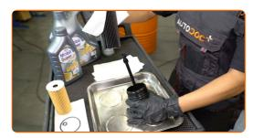
Retire las juntas tóricas viejas de la tapa del filtro de aceite. Utilice un destornillador plano.
