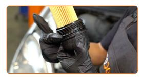
Instale la tapa del cuerpo del filtro de aceite y atorníllela. Use un vaso de impacto del n.º 32. Utilice una llave dinamométrica. Apriételo a un par de 25 Nm.
