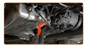
Destornille el tapón de desagüe. Use un vaso de impacto del n.º 18. Utilice una llave de trinquete.
