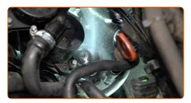
Destornille la tapa del cuerpo del filtro junto con el elemento filtrante antiguo. Use un vaso de impacto del n.º 32. Utilice una llave de trinquete.
