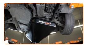
Limpie el área del orificio de drenaje de la bandeja de aceite. Use un cepillo de alambre. Utilice un spray de limpieza multiuso.
