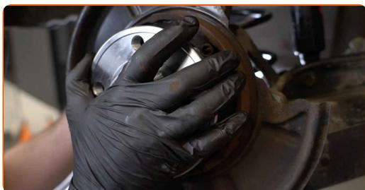
**24** Apriete la sujeción del rodamiento de cubo de rueda. Use un vaso de impacto del n.º E16. Utilice una llave dinamométrica. Apriételo a un par de 120 Nm.
