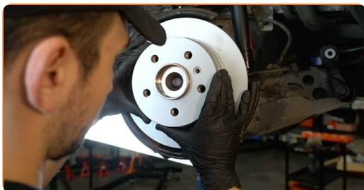
**29** Apriete la fijación del disco de freno. Utilice Torx T30. Utilice una llave dinamométrica. Apriételo a un par de 9 Nm.
