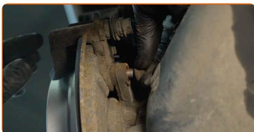
**32** Apriete la fijación de la pinza del cáliper de freno. Use un vaso de impacto del n.º 16. Utilice una llave dinamométrica. Apriételo a un par de 55 Nm.
