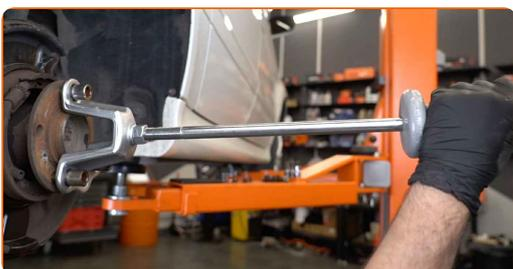
**22** Limpie el asiento de montaje del cojinete del cubo (buje). Use un cepillo de alambre. Use el aerosol WD-40.
