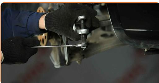
**18** Limpie la sujeción del sensor del ABS. Use un cepillo de alambre. Use el aerosol WD-40.
