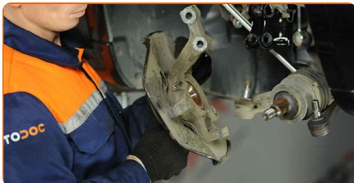
**30** Presione para que el cubo de rueda salga del anillo interior del cojinete. Utilice un juego de cubos y rodamientos. Utilice un martillo.
