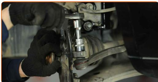
**48** Apriete la sujeción del cubo. Use un vaso de impacto del n.º 30. Utilice una llave dinamométrica. Apriételo a un par de 100 Nm.+60°
