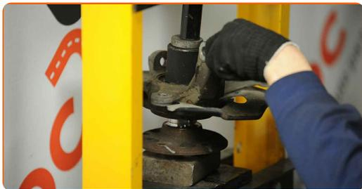
**37** Instale el muñón de dirección una vez ensamblado con el cubo.
