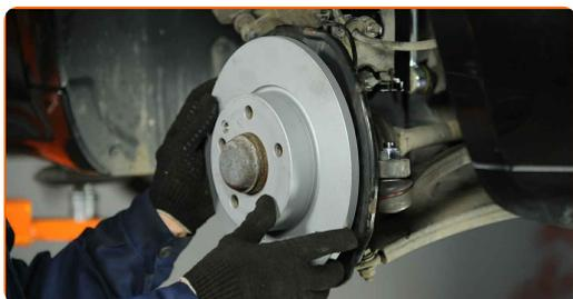
**53** Apriete la fijación del disco de freno. Utilice Torx T30. Utilice una llave dinamométrica. Apriételo a un par de 9 Nm.
