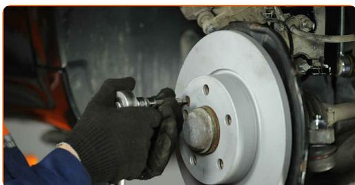
**54** Limpie los asientos de montaje de la pinza de freno y su soporte. Use un cepillo de alambre. Use el aerosol WD-40.
