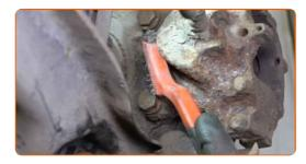
Desenrosque las sujeciones de la pinza de freno. Use un vaso de impacto del n.º 16. Utilice una llave de trinquete.
