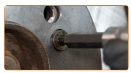
Apriete las sujeciones del disco de freno. Use Vaso HEX No. H5. Utilice una llave dinamométrica. Apriételo a un par de 10 Nm.
