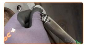
Trate los pistones de la pinza de freno. Utilice un cepillo de limpieza de nylon. Use un limpiador de frenos.
