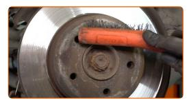
Desenrosque las sujeciones del disco de freno. Use Vaso HEX No. H5. Utilice una llave de trinquete.
