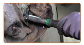
Trate la superficie de las pastillas de freno que entra en contacto con la pinza de freno. Use pasta antichirridos.
