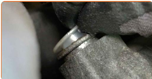
**10** Separe los conectores del cableado de las bujías de precalentamiento. Utilice unos alicates de punta de aguja.
