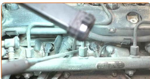
**4** Trate las bujías de precalentamiento. Use el aerosol WD-40.
