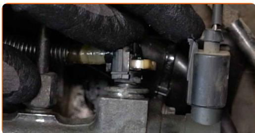
**22** Apriete la sujeción de la manguera de combustible. Use un vaso de impacto del n.º E11. Utilice una llave dinamométrica. Apriételo a un par de 8 Nm.
