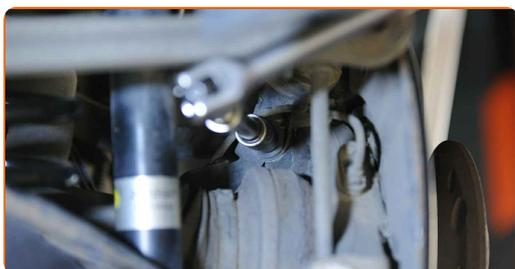
**30** Retire el perno de sujeción. Use un punzón. Utilice un martillo.
