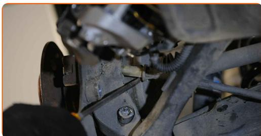
**19** Limpie las sujeciones del brazo de control. Use un cepillo de alambre. Use el aerosol WD-40.
