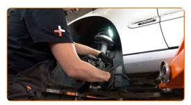
Destornille el latiguillo de freno del cáliper de freno.
