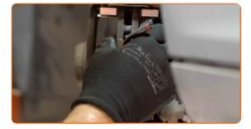
Instale el latiguillo de freno en la pinza de freno nueva.
