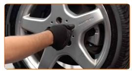
Baje el automóvil y, manteniendo el orden cruzado, apriete los pernos de fijación de las ruedas. Utilice una llave dinamométrica. Apriételo a un par de 110 Nm.
