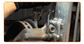
Afloje la fijación del latiguillo de freno. Usa una llave mixta del n.º 14.
