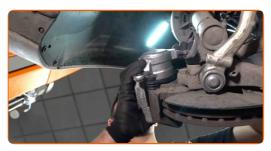
Atornille en las sujeciones de la pinza de freno.
