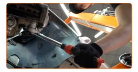
Apriete la sujeción del latiguillo de freno. Usa una llave mixta del n.º 14. Utilice una llave dinamométrica. Apriételo a un par de 18 Nm.
