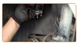
Conecte la clavija del sensor de desgaste de las pastillas de freno.
