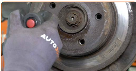
**19** Retire el perno de sujeción.
