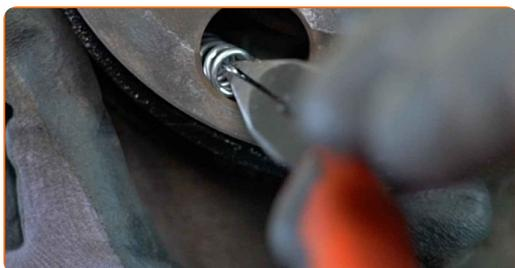
**31** Instale el muelle de retorno inferior. Utilice un destornillador plano.
