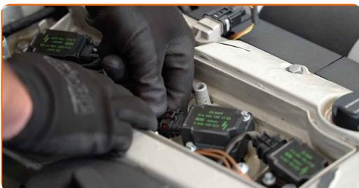
**6** Destornille la atadura de la bobina del encendido. Use un vaso de impacto del n.º E8.
