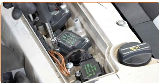
**7** Saque la bobina de ignición del pozo de la bujía.
