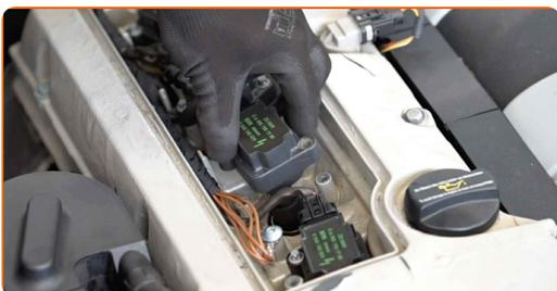
**8** Trate la punta de la bobina de encendido. Utilice una grasa de alta temperatura. Utilice un destornillador plano.
