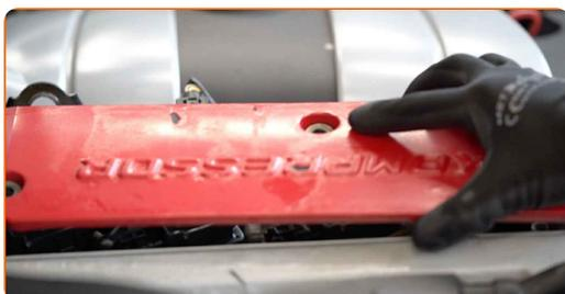
**5** Desconecte el conector de la bobina de ignición.
